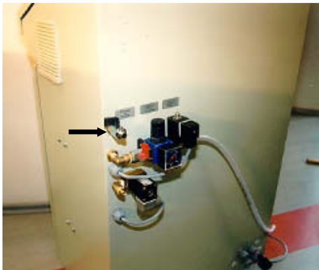
Abb. 7 Luftabsperrrventil an der Gehäuserückwand
