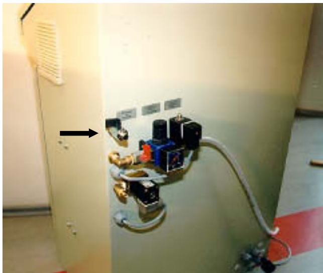
Abb. 11 Luftabsperrrventil an der Gehäuserückwand
