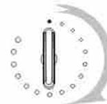
• Wenn der Raum sehr feucht ist, den Feuchtigkeitsregler auf die Position „continue“ drehen, damit das Gerät im Dauerbetrieb arbeitet.
