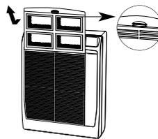
Fassen Sie den Griff am oberen Ende des Filters und ziehen Sie nach oben. Den Luftfilter vor dem Wiedereinsetzen reinigen.
