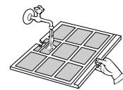
Den filter mit einem Staubsauger reinigen. Ist öliger Staub vorhanden, ist der Filter mit lauwarmen Seifenwasser zu waschen, zu spülen und trocknen zu lassen.
