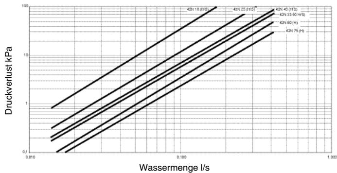
Druckverlust, Vierleiter-Wärmetauscher (Kaltwasser-Wärmetauscherkreislauf)
