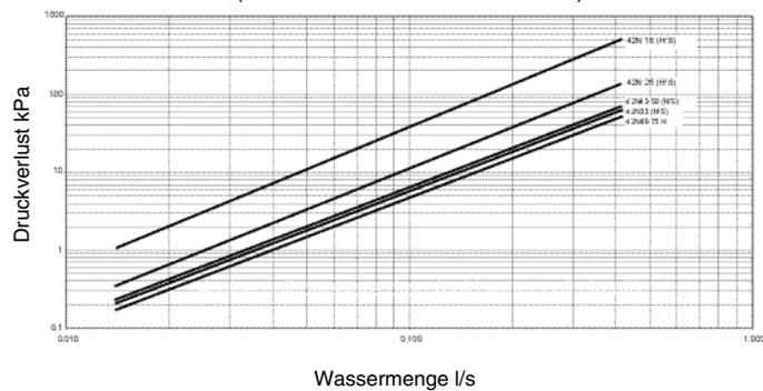
Druckverlust, Vierleiter-Wärmetauscher (Warmwasser-Wärmetauscherkreislauf)
