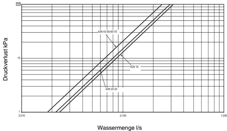
Der Druckverlust gilt nur für den Wärmetauscher, ausschließlich der Wasseranschlüsse und Ventile.
