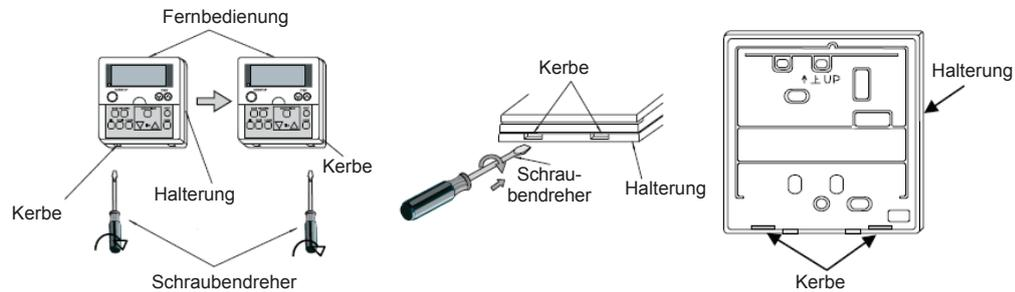
2. Befestigen Sie die Fernbedienung an der Halterung, wie im Folgenden beschrieben:
