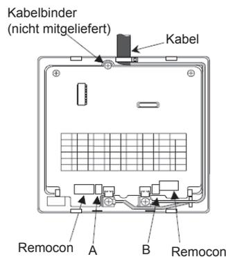
3. Führen Sie das Ende des Kabels, an dem Sie die Ummantlung entfernt haben, durch die Aussparung.
