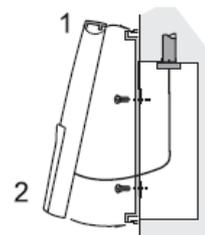
1. Drücken Sie die Haken der Fernbedienung in die sich oben an der Halterung befindlichen Kerben.
