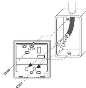
3. Entfernen Sie die Isolierung am Ende des Kabels und klemmen Sie die lötfreien Klemmen M3 an.
