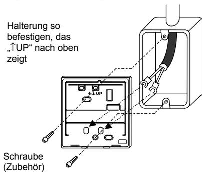
3. Entfernen Sie die Isolierung am Ende des Kabels und klemmen Sie die lötfreien Klemmen M3 an.
