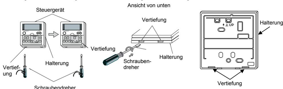
2. Befestigen Sie die Fernbedienung an der Halterung, wie im Folgenden beschrieben:
