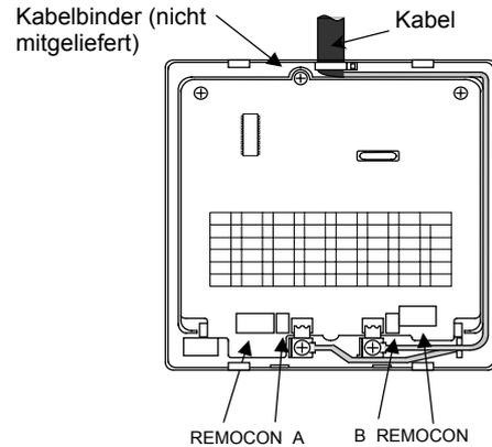
3. Führen Sie das Ende des Kabels, an dem Sie die Ummantelung entfernt haben, durch die Aussparung.
