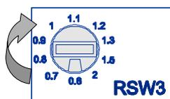
Beim **Heizkörperbetrieb** (oder Kombination aus Heizkörper und Bodenheizung) ist zu empfehlen, den Drehschalter auf die Ziffern 1.1/1.2/1.3/1.5/2 zu stellen (Einstelltemperatur wird erhöht durch Umschalten der Drehschalterstellung von 1.1 zu 2).
