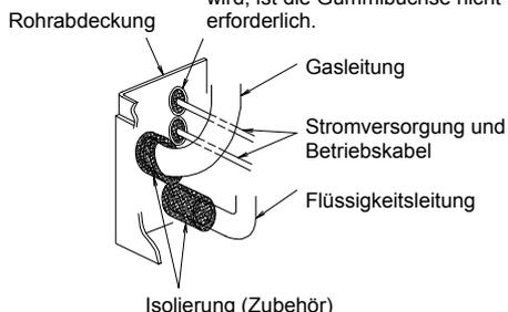
Bringen Sie die Isolierung wie auf der Abbildung gezeigt am Rohr an; an der Kabeldurchführung darf kein Spalt mehr vorhanden sein. Schneiden Sie die Isolierung wie in der Abbildung gezeigt, falls das Anbringen schwierig ist.
