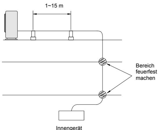
Befestigen Sie die Kältemittelleitung nicht mit Metallmaterial, da sich die Leitung ausdehnen und zusammenziehen kann.
