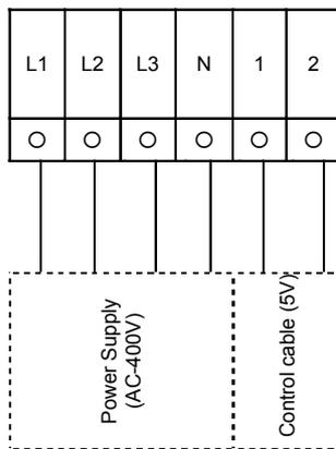
Anweisungen für die Verkabelung an der Klemmleiste
