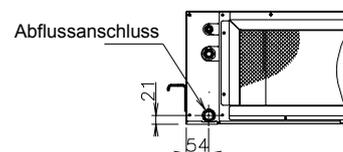
■ **Installation für normalen Abfluss: (durch Schwerkraft)**
