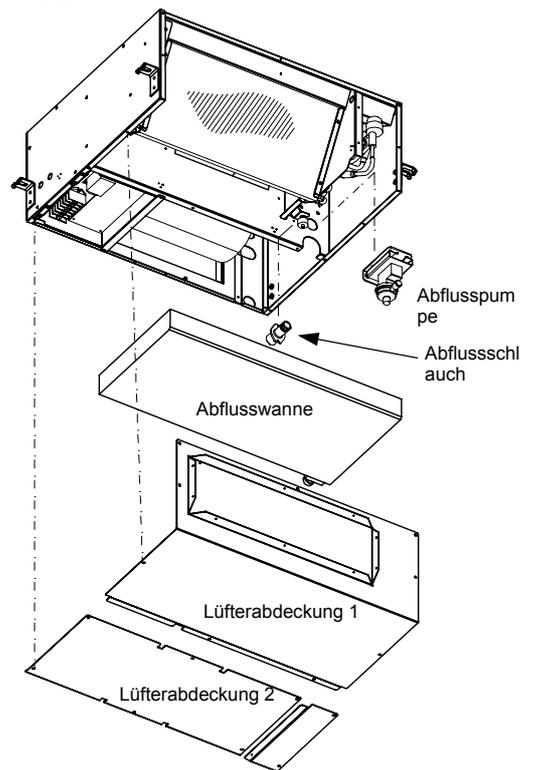
Bei Installation des optionalen Abflussmechanismus:
