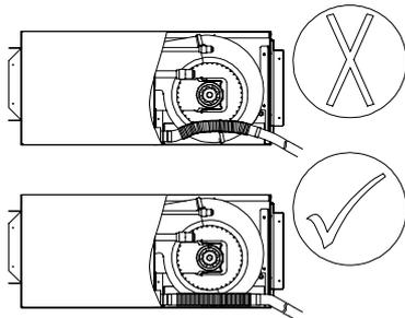
2. Absaugrohr wie unten gezeigt anschließen.
