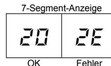
Im Falle einer Störung ist entweder die HARC-PCB beschädigt oder es besteht ein Problem mit der H-LINK-Leitung, wie beispielsweise eine falsche Verkabelung oder eine falsche Einstellung des Endklemmenwiderstandes.
