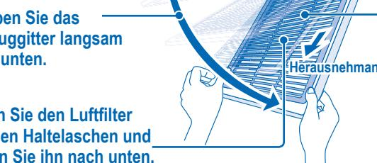
3 Lösen Sie den Luftfilter aus den Haltelaschen und ziehen Sie ihn nach unten.
