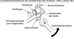
• Während des Kühlbetriebs unter niedrigem Umgebungsdruck, kann die niedrige Druckseite des Ventils anfällig auf Frost sein. Um dies zu vermeiden, sollte der Bereich um die Überwurfmutter mit einem Silikondichtmittel abgedichtet werden.
