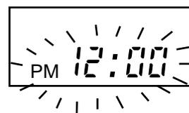
Falls nach dem Einlegen der Batterien keine Anzeige erscheint, entfernen Sie die Batterien und legen Sie sie erneut ein.
