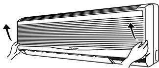
Hierzu drücken sie auf die Druckpunkte zum Öffnen des Frontgitters und klappen das Frontgitter nach vorne hoch.
