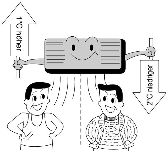
■ Reinigen Sie den Luftfilter in regelmäßigen Abständen. Durch verschmutzte Filter werden die Zuluftmenge und die Kühl- bzw. Heizleistung reduziert. Wenn die Filter nicht etwa alle zwei Wochen gereinigt werden, erhöhen sich die Stromkosten um etwa 6 %.
