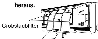
Fassen Sie die Grobstaubfilter an der Lasche an, heben Sie sie leicht an und ziehen Sie sie heraus.
