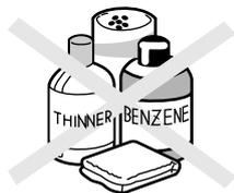
Zum Reinigen des Klimageräts dürfen aus folgenden Gründen weder Wasser noch Lösungsmittel verwendet werden:
