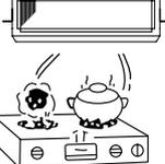
Platzieren Sie keine feuchten Gegenstände nahe dem Gerät, da im Kühlbetrieb bei einer Luftfeuchte über 80 % Kondensat aus dem Gerät tropfen kann.
