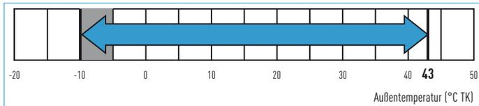
Betriebsbereich Heizen: Stabiler Heizbetrieb selbst bei Außentemperaturen bis  $-20^{\circ}\text{C}$ . Der Heizbereich konnte durch einen Verdichter mit Hochdruckgehäuse auf bis zu  $-20^{\circ}\text{C}$  ausgedehnt werden.
