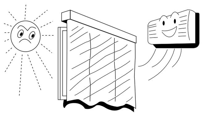
■ Achten Sie stets auf eine richtige Einstellung der Luftstromrichtung. Bringen Sie die Luftleitlamellen zum Kühlen in die waagerechte Stellung. Dies erhöht die Wirksamkeit des Kühlbetriebs.
