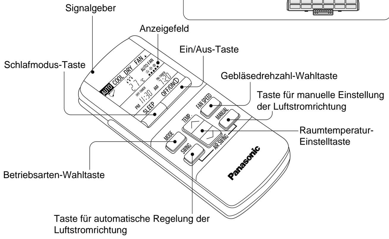
**Nach Öffnen der Klappe stehen weitere Funktionen und Anzeigen zur Verfügung.**
