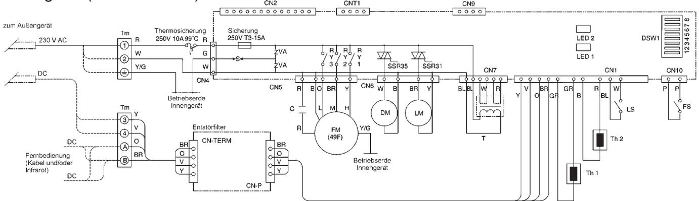
Achtung: Klemmen 3, 4, A und B sind Gleichspannungs-Kommunikationsanschlüsse. Hier darf keine Leistungsspannung angeschlossen werden.
