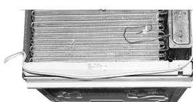
Anschlußkabel nach links geführt
