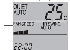
Die Ventilator-drehzahl wird automatisch niedriger eingestellt als vorgegeben.
