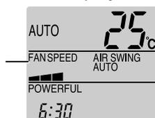
Die Ventilator-drehzahl wird automatisch höher eingestellt als vorgegeben.
