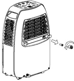
Entfernen Sie die Kappe von der Abflussöffnung, indem Sie sie gegen den Uhrzeigersinn drehen.
