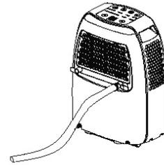
Schließen Sie den PVC-Schlauch (nicht im Lieferumfang enthalten) an die Öffnung des Dauerabflusses an. Schließen Sie den Schlauch an einen Dauerabfluss an.
