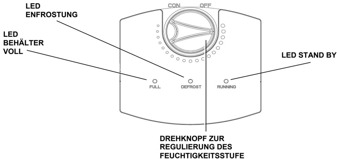
**DREHKNOPF ZUR FEUCHTIGKEITSREGULIERUNG:** zur Einstellung des gewünschten Prozentsatzes der Feuchtigkeit. Wenn Sie, vor dem Gerät stehend, den Drehknopf ganz nach links drehen, wählen Sie die OFF-Position = das Gerät wird ausgeschaltet.
