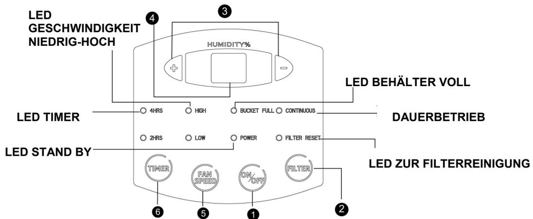
**1. TASTE ON/OFF:** diese Taste zum Ein- und Ausschalten des Luftentfeuchters betätigen.
