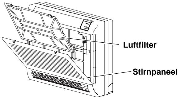
1. Öffnen Sie das Stirnpaneel, indem Sie die zwei Punkten "PUSH" drücken, dann ziehen Sie an sich.
