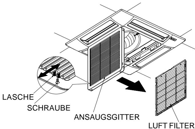
1. Die Schrauben auf jeder Seite mit einem Schraubenzieher von den Laschen entfernen.
