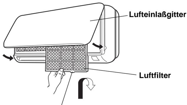
**In die Nut am Gerät einpassen.**
