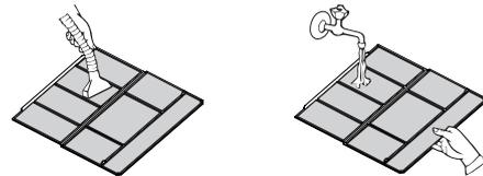
Den Filter mit einem Staubsauger reinigen. Ist öliges Staub vorhanden, ist der Filter mit lauwarmen Seifenwasser zu waschen, zu spülen und trocknen zu lassen.
