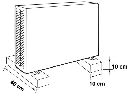
Preparar la unidad exterior sobre una base sólida por encima del suelo y fijarla con los cuatro pernos de expansión.
