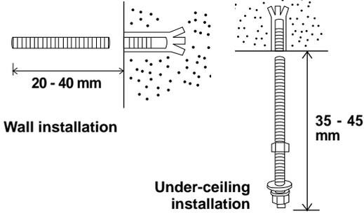
**P****KIT PARA INSTALAÇÕES À PAREDE OU AO TETO (FORNECIDO COM A UNIDADE)**
