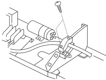
**P** Posicione o fio elétrico para a ligação com os terminais e ligue-o (consulte o esquema elétrico para a ligação). Fixe o fio com uma anilha especial à braçadeira.
