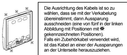
3 Das Kabel durch die Nut führen.
