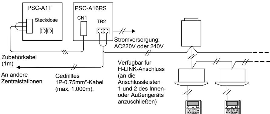
Verfügbar für H-LINK-Anschluss (an die Anschlussleisten 1 und 2 des Innen- oder Außengeräts anzuschließen)
