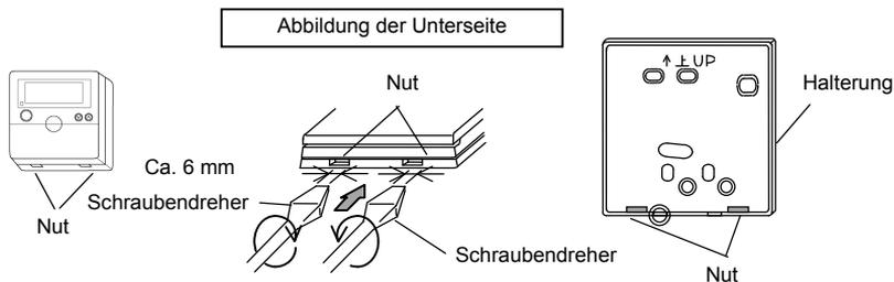
2. Die Zeitschaltuhr an der Halterung befestigen und das Kabel wie folgt anschließen.
