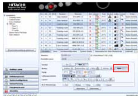
In Jahreszeiten ohne extreme Temperaturen berechnet CSNET WEB in den oben genannten Systemen den Hauptbedarf der Innengeräte für jedes Außengerät, wählt den erforderlichen Betriebsmodus für die meisten Geräte des Systems und stellt die Fernbedienungen entsprechend ein.
