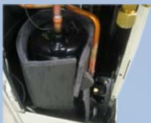
Kompressor mit Schallsisolierung
