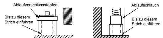
Einen Polyvinylchlorid-Schlauch (PVC) mit Außendurchmesser 26 mm vorbereiten.
