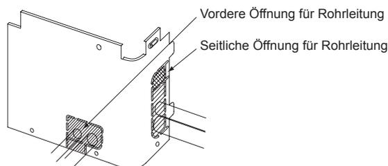
Überprüfen Sie bei der Verwendung von Einsteck- oder Führungsrohren deren Durchmesser und entfernen Sie den mit gekennzeichneten Teil entlang des Schlitzes.
