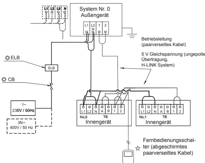
**Unabhängige Stromversorgung des Außengeräts und des Innengeräts**
