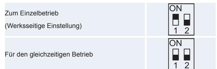
Ist die Anzahl der Außengeräte in demselben H-LINK größer als 2, stellen Sie den Pin Nr. 1 von DSW5 bei der zweiten Außengeräte-Kühlleinheit auf „OFF“. Wird nur ein Außengerät benutzt, ist keine Einstellung erforderlich. **Einstellung der Kühlkreislaufnr.**
