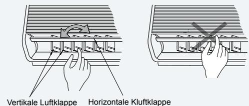
Vertikale Luftklappe    Horizontale Luftklappe
