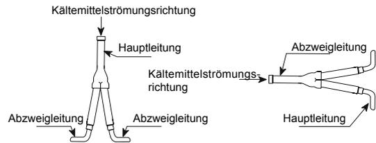
4 Korrekte Position beim Dreifachabzweigerohr.
