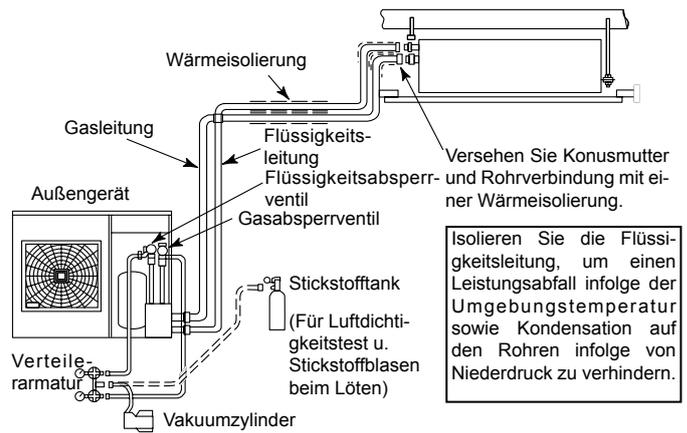
Isolieren Sie die Flüssigkeitsleitung, um einen Leistungsabfall infolge der Umgebungstemperatur sowie Kondensation auf den Rohren infolge von Niederdruck zu verhindern.
