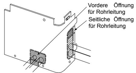
Überprüfen Sie bei der Verwendung von Einsteck- oder Führungsrohren deren Durchmesser und entfernen Sie den mit gekennzeichneten Teil, indem Sie dem Schlitz folgen.
