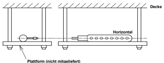
Hängen Sie das Verteilerrohr so unter die Decke, so dass dessen Öffnungen
