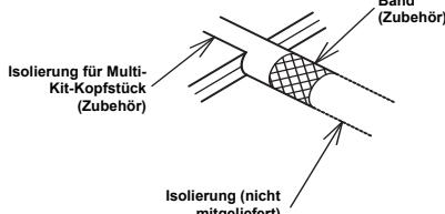
c) Befestigen Sie die Isolierung (Zubehör) am zu verschließenden Rohr. Dichten Sie das Isolierverbindungsstück anschließend mit Band (Zubehör) ab.
