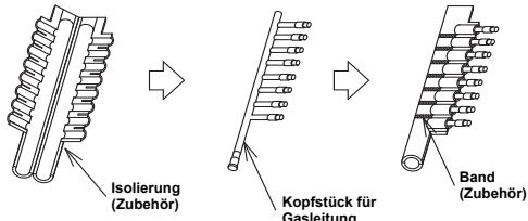
b) Dichten Sie das Isolierverbindungsstück mit Band (Zubehör) ab.
