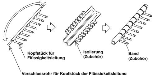
b) Kürzen Sie die Isolierung für das Flüssigkeitsrohr so lange, bis es an das Anschlussstück gesetzt werden kann.
