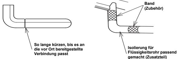
c) Dichten Sie das Verbindungsstück des Verschlussrohrs mit Band (Zubehör) ab, nachdem die Isolierung des Flüssigkeitsrohrs angebracht ist.
