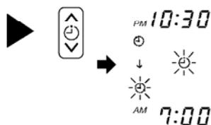
**5** Das Signalfenster der Fernbedienung auf die Zimmereinheit richten und die I (RESERVIERUNG)-Taste drücken.
