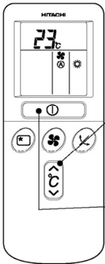
Die (START/STOPP)-Taste drücken. Der Heizbetrieb beginnt mit einem Piepton. Diese Taste nochmals drücken, um den Betrieb zu stoppen.
