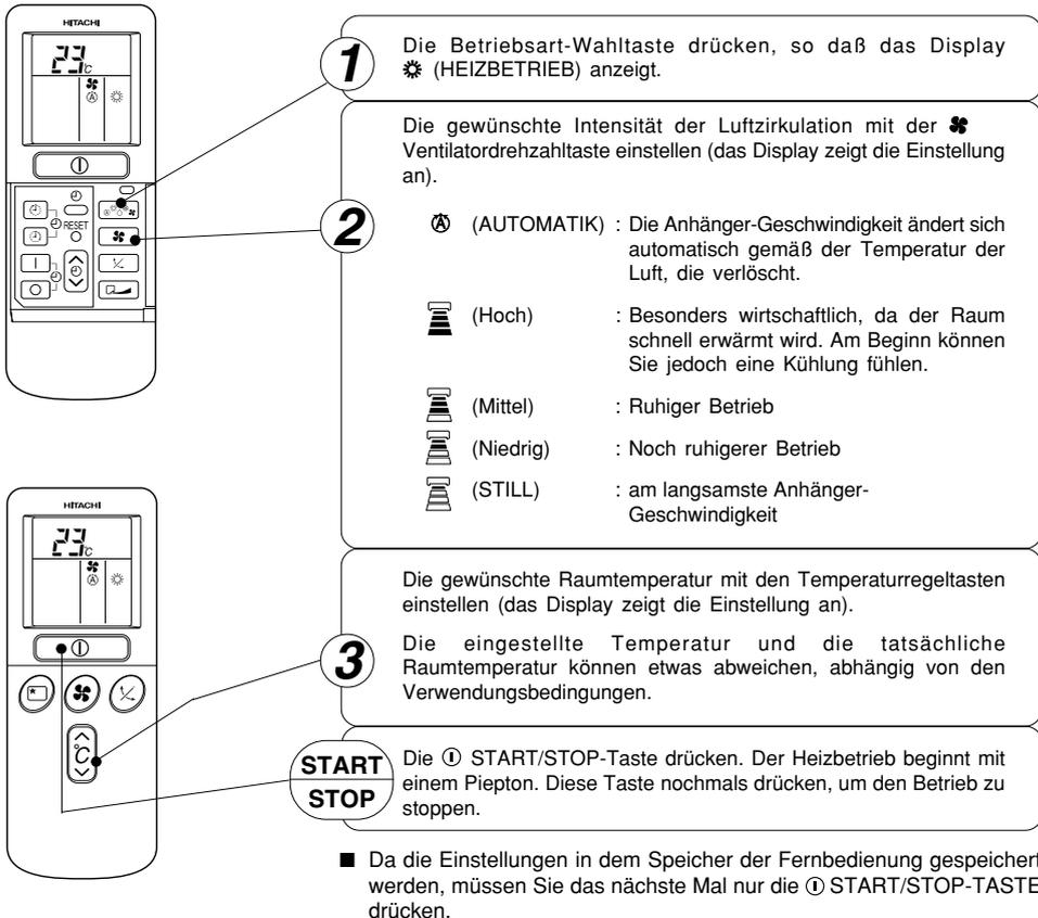
Das Diagramm zeigt zwei Ansichten der Fernbedienung. Die obere Ansicht ist mit einer '1' markiert und zeigt die Auswahl der Heizfunktion (Heizsymbol) auf dem Display. Die mittlere Ansicht ist mit einer '2' markiert und zeigt die Einstellung der Ventilatorgeschwindigkeit (Fächer-Symbole). Die untere Ansicht ist mit einer '3' markiert und zeigt die Einstellung der Raumtemperatur (Temperatur-Symbole). Ein 'START STOP' Symbol ist ebenfalls eingezeichnet.
