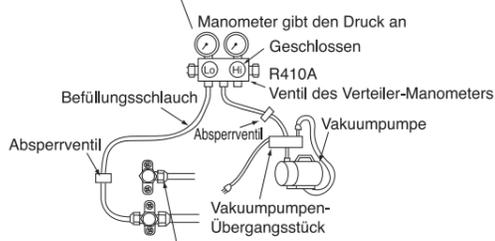
Bei Beginn des Pumpvorgangs, die Gewindemutter leicht lösen, um zu prüfen, ob Luft angesaugt wird. Dann die Gewindemutter wieder anziehen.
