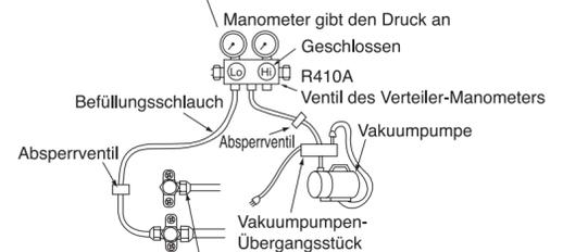
Bei Beginn des Pumpvorgangs, die Gewindemutter leicht lösen, um zu prüfen, ob Luft angesaugt wird. Dann die Gewindemutter wieder anziehen.
