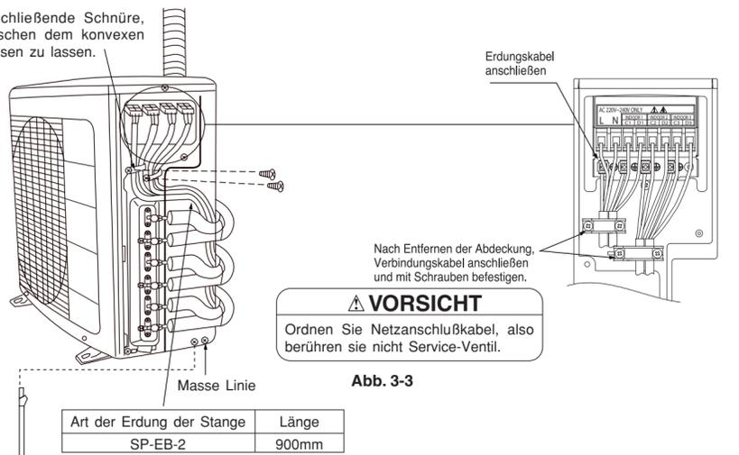
Nach Entfernen der Abdeckung, Verbindungskabel anschließen und mit Schrauben befestigen.
