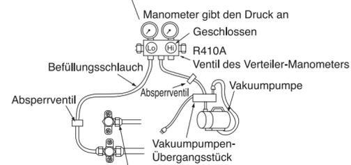
Bei Beginn des Pumpvorgangs, die Gewindemutter leicht lösen, um zu prüfen, ob Luft angesaugt wird. Dann die Gewindemutter wieder anziehen.
