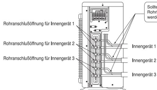
Sollte anschließende Schnur mit Rohrleitung mit Klebeband geordnet werden zuerst.
