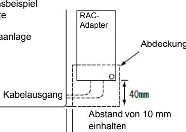
Installation an der Raumklimaanlage verwendet.
