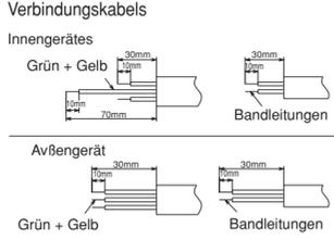
Einzelheiten zum Abschneiden des Verbindungskabels
