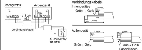
Einzelheiten zum Abschneiden des Verbindungskabels
