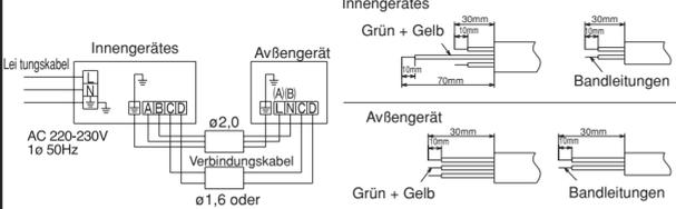
Bei Stromversorgung zum Außengerät
