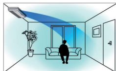
Die kühle Luft verteilt sich von oben im ganzen Raum.
