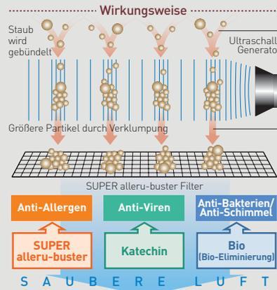
**1 Ultraschallwellen scheiden Staub ab**
