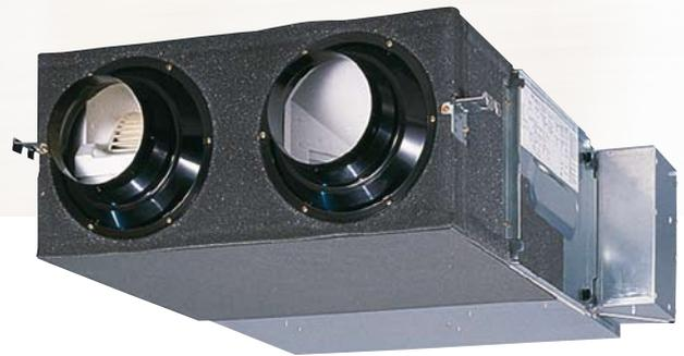
Lüftungseinheiten mit Wärme- und Feuchterückgewinnung bieten einen hohen Komfort sowie ein hohes Energieeinsparpotenzial, denn sie gewinnen aus der Abluft während des Lüftungsvorgangs sowohl die sensible Wärme (Temperatur) als auch die latente Wärme (Feuchte) zurück.
