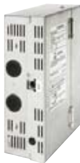
(H x B x T): 248 x 185 x 80 mm 100 bis 240 V AC (50/60 Hz), 17 W (getrennte Stromver-sorgung)
