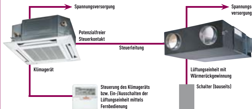
Typische Kombination aus Lüftungseinheit und Klimagerät
