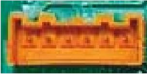
Das Anschließen eines Innengeräts an ein externes Gerät ist kinderleicht. Der auf der Platine aller Innengeräte befindliche T10-Steckanschluss ermöglicht eine digitale Verbindung zu externen Geräten.
