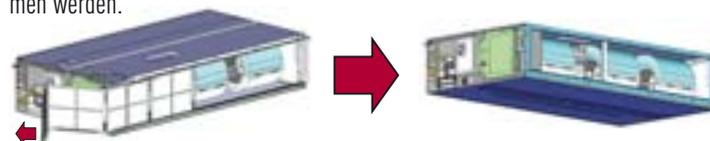
Wenn auf der Saugseite ein Luftansaugkanal (bauseits) installiert wird, müssen der Filter sowie der Rahmen und das Dämmmaterial auf beiden Seiten des Geräts entfernt werden. Anschließend wird der Luftkanal auf der Saugseite mit Hilfe der vorhandenen Montagebohrungen am Gerät montiert.
