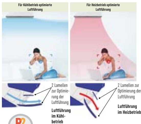
Für Kühlbetrieb optimierte Luftführung
