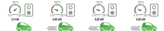
**Nicht-Inverter** Die abgegebene Leistung schießt über das Ziel hinaus. Die Wärmeabgabe schwankt sehr stark, was zu einem erhöhten Verbrauch führt.
