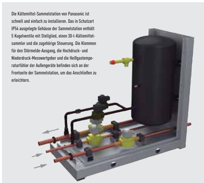
Die Kältemittel-Sammelstation von Panasonic ist schnell und einfach zu installieren. Das in Schutzart IP54 ausgelegte Gehäuse der Sammelstation enthält 5 Kugelventile mit Stellglied, einen 30-l-Kältemittelsammler und die zugehörige Steuerung. Die Klemmen für den Störmelde-Ausgang, die Hochdruck- und Niederdruck-Messwertgeber und die Heißgastemperaturfühler der Außengeräte befinden sich an der Frontseite der Sammelstation, um das Anschließen zu erleichtern.
