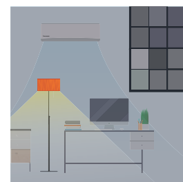
Sonnenlichterfassung Econavi passt die Kühl- oder Heizleistung je nach Sonneneinstrahlung an.
