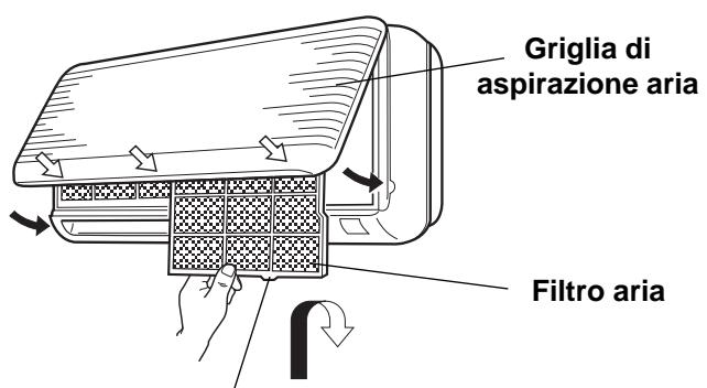
**Inserite nella scanalatura sul sistema.**
