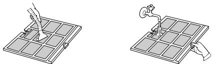
Pulire il filtro con una aspirapolvere. In presenza di polvere oleosa lavate con acqua saponata tiepida, risciacquate e lasciate asciugare.
