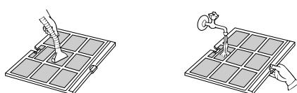
Den Filter mit einem Staubsauger reinigen. Ist öliger Staub vorhanden, ist der Filter mit lauwarmen Seifenwasser zu waschen, zu spülen und trocknen zu lassen.
