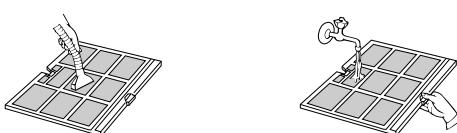
Utiliser un aspirateur pour enlever la poussière. Si la poussière colle au filtre, laver le filtre avec de l'eau tiède et savonneuse, le rincer à l'eau claire et le sécher.
