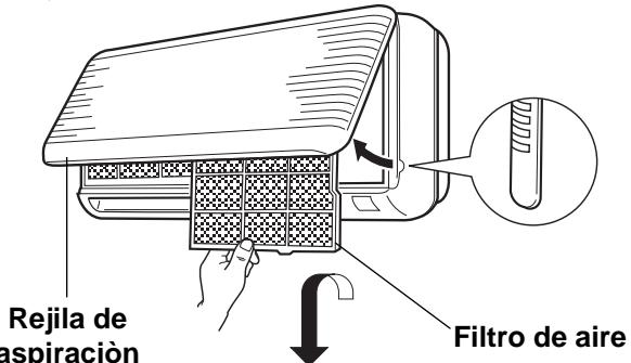
1. Sujetar las dos extremidades de la rejilla de aspiración y tirar hacia afuera y hacia arriba.
