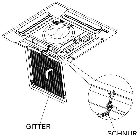
1. Die Sicherheitschnur von den Rahmen entfernen (versichern Sie sich sie nach beendeter Arbeit wieder zu befestigen).
