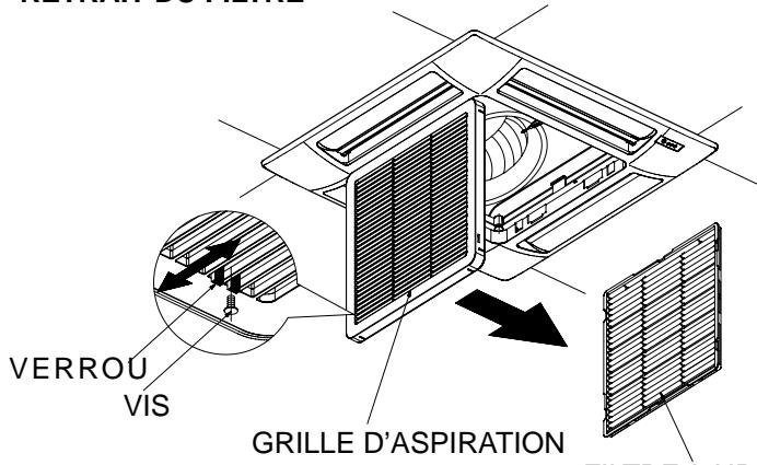
1. A l'aide d'un tournevis, déposer la vis du verrou de chaque côté.
