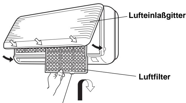
**In die Nut am Gerät einpassen.**
