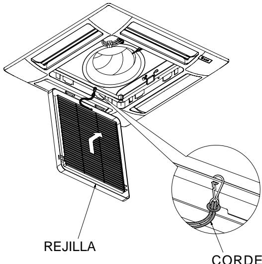
1. Retire el cordel de seguridad del bastidor(recordar de engancharlo otra vez cuando termine el trabajo).
