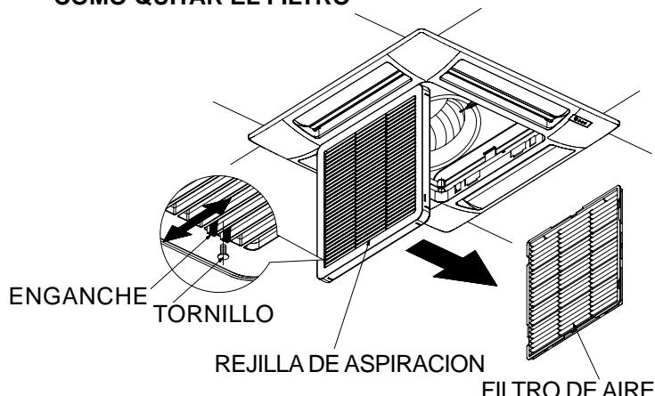
1. Retire el tornillo del enganche de ambos lados con un destornillador.
