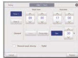
Bildschirmanzeige für Leistungsbegrenzung (Lastabwurf) des Außengeräts.
